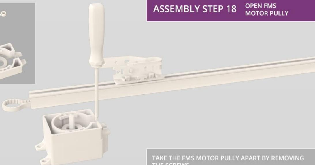
TAKE THE FMS MOTOR PULLY APART BY REMOVING THE SCREWS
